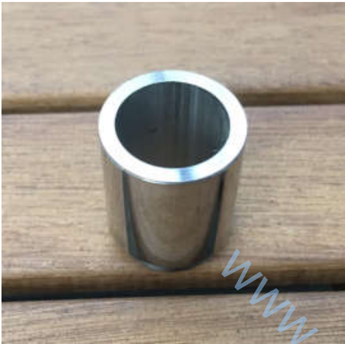
Passende Stücke abgeflex und abgedreht.
