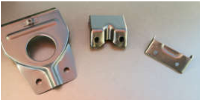
Oben und unten: Auch das Scharnier und die Platte wurden komplett entrostet und bekamen ein neues Finish
