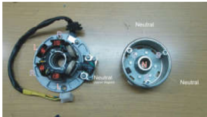
"L" und "R" bezeichnet die Wicklungsrichtung, "N" und "S" Nord- und Südpol
