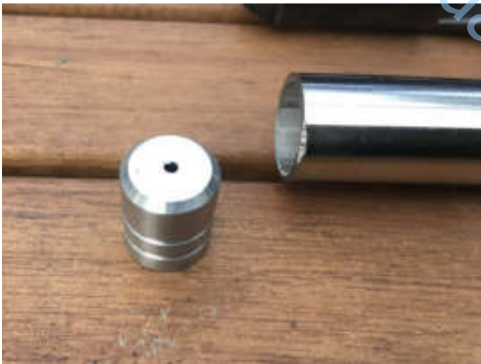
Der Abschluss kommt aus dem Möbelbereich: Endstück Für die Einbuchtung habe ich mir ein Presswerkzeug gebaut und die Hydraulikpresse von einem Kumpel benutzt.
