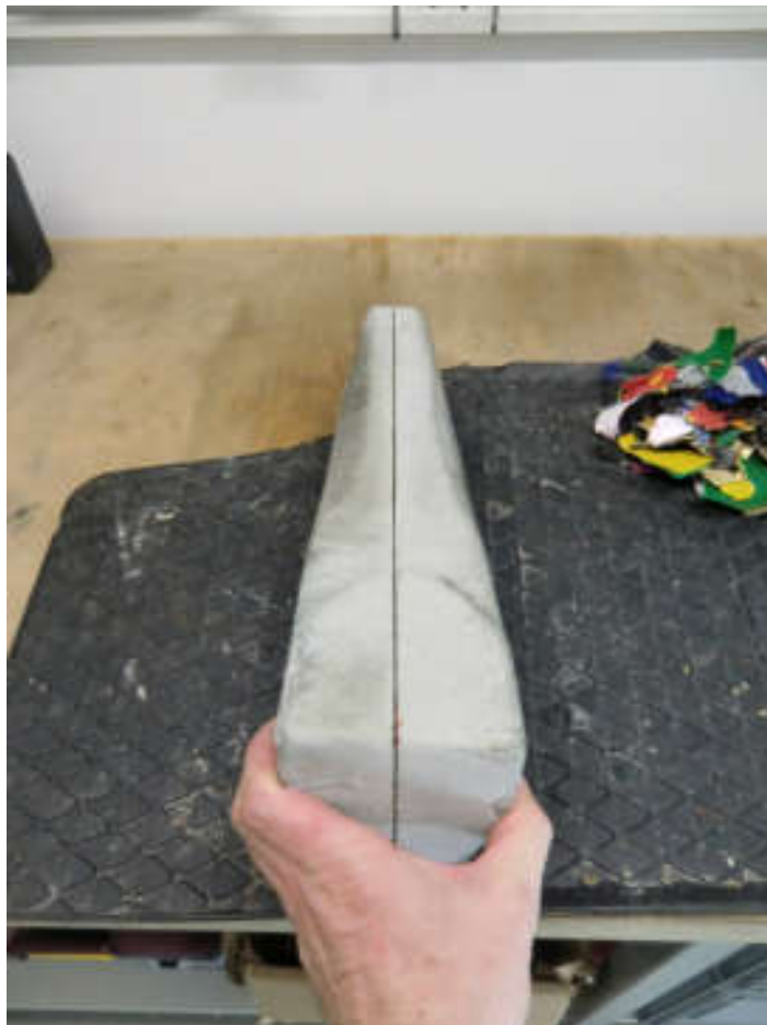
Oben: Die gegossenen Formen fast fertig – diese dienen zum späteren Tiefziehen des Kunststoffes
