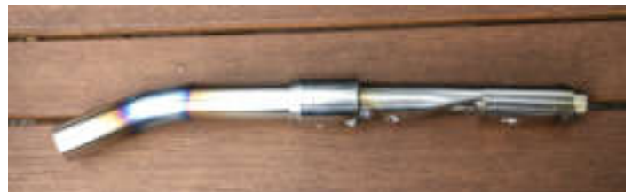
Der Abschluss kommt aus dem Möbelbereich: Endstück Für die Einbuchtung habe ich mir ein Presswerkzeug gebaut und die Hydraulikpresse von einem Kumpel benutzt.
