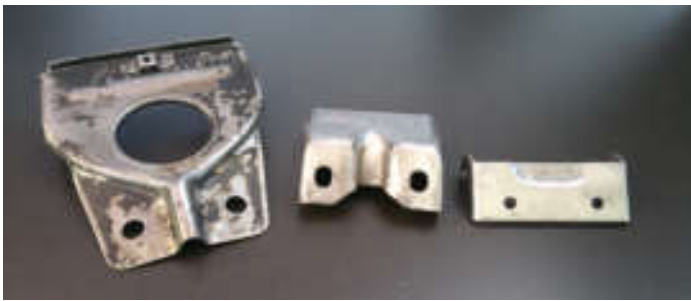
Oben und unten: Auch das Scharnier und die Platte wurden komplett entrostet und bekamen ein neues Finish
