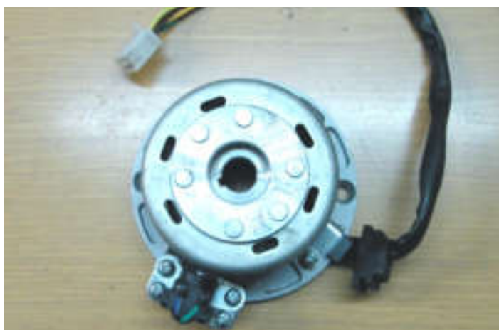
Masse 500g, Außendurchmesser 88mm, Innendurchmesser 77mm, Luftspalt ca.1mm
