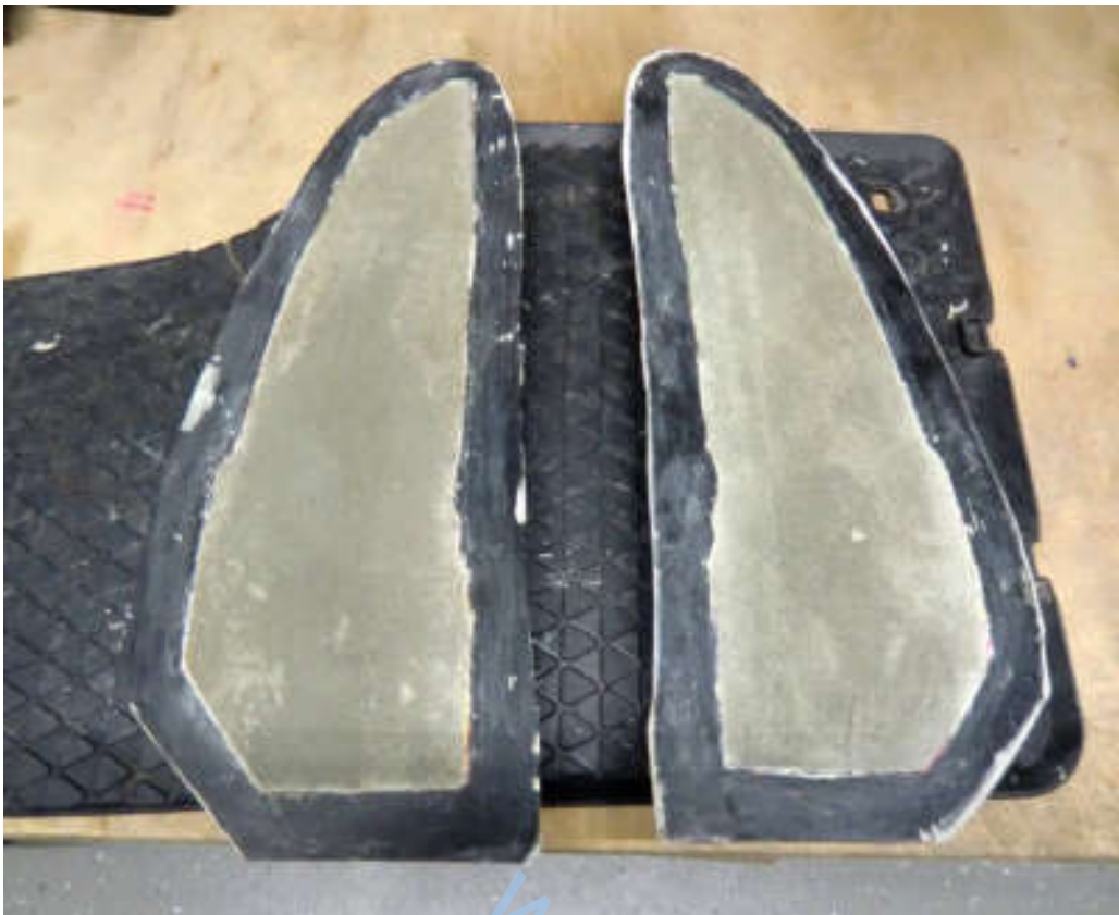
Links: Die gegossenen Tankhälften 24 Stunden nach dem Guss.
